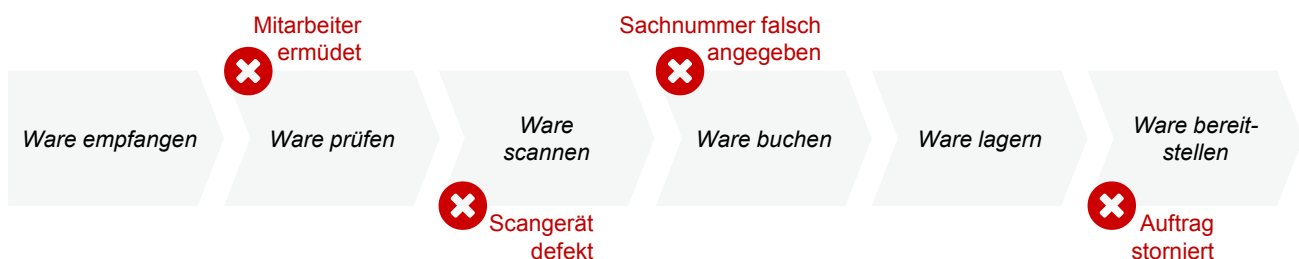
Abb. 1: Beispielhafter Wareneingangsprozess mit potentiellen Störgrößen.
